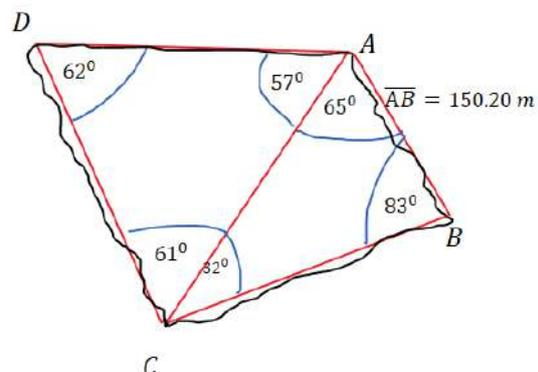
Gráfico 98. División en triángulos del terreno irregular
